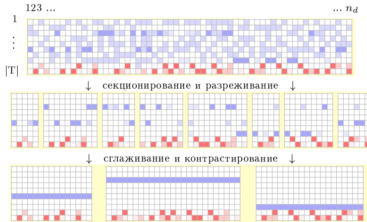
Рис. 20: Эвристическая пост-обработка E-шага для выделения тематически однородных сегментов текстового документа d = \{w_1, \dots, w_{n_d}\} длины n_d . Фоновые темы не участвуют в пост-обработке.
