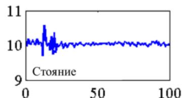
Абсолютные значения ускорения акселерометра мобильного телефона для различных классов физической активности
