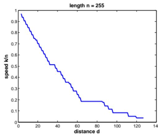
Графики скорости  $k/n$  кодов БЧХ в зависимости от кодового расстояния  $d$  для данной длины кода  $n$ .
