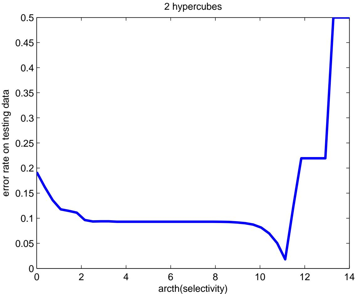
Рис. 2: Зависимость доли ошибок на контрольной выборке от значения параметра селективности
