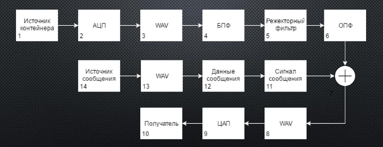
NOTCH FILTER (950 – 1050 HZ, 1450 – 1550 HZ)
